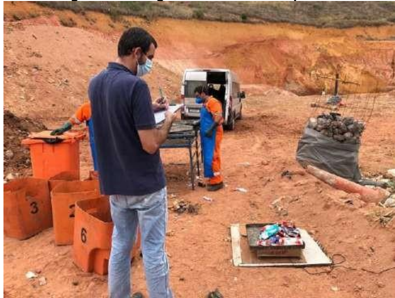
Figura 37: Pesagem dos Resíduos Separados
